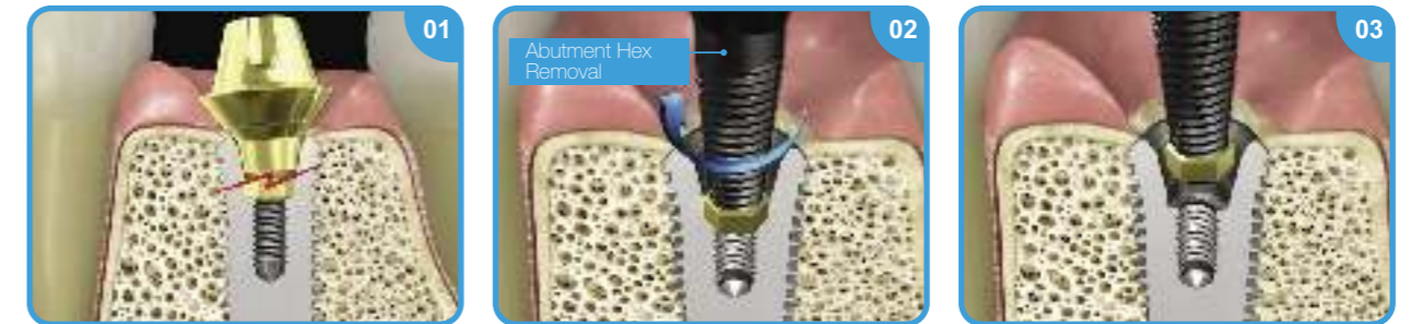
01. 파절된 Abutment Hex 02. Abutment Hex Removal을 파절된 Abutment Hex가 걸릴때까지 시계방향으로 돌려준다. (무리한 힘을 가하면 Fixture가 움직일 수 있다.) 03. Abutment Hex를 제거한다.
